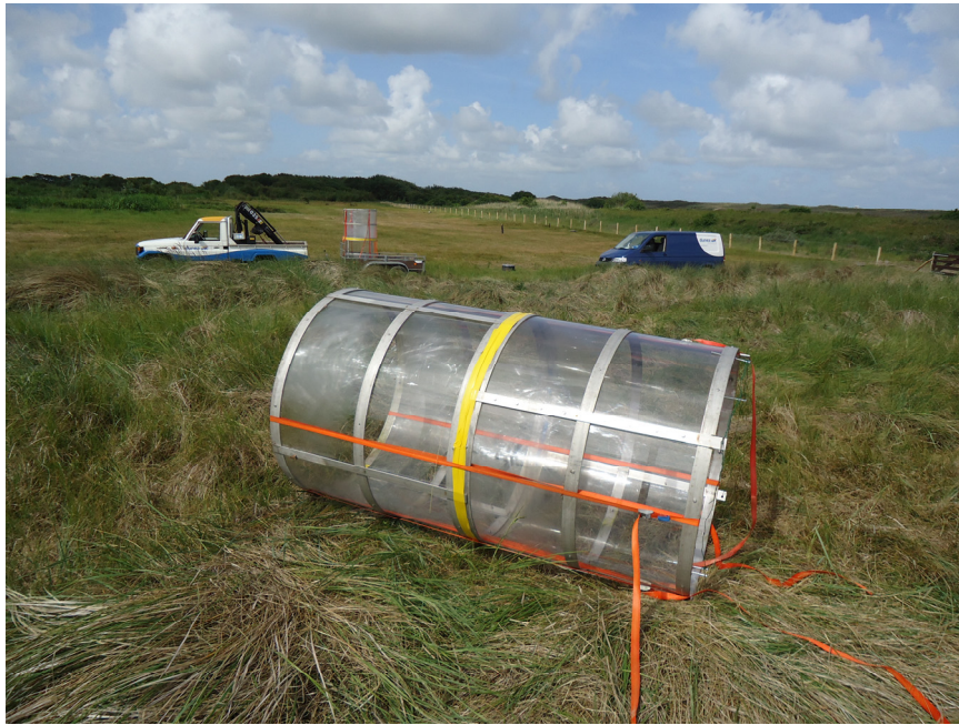
Figuur 6.1. Een enclosure, voordat deze in het water geplaatst werd, hoogte 1,8 meter en doorsnede 1,0 meter.
