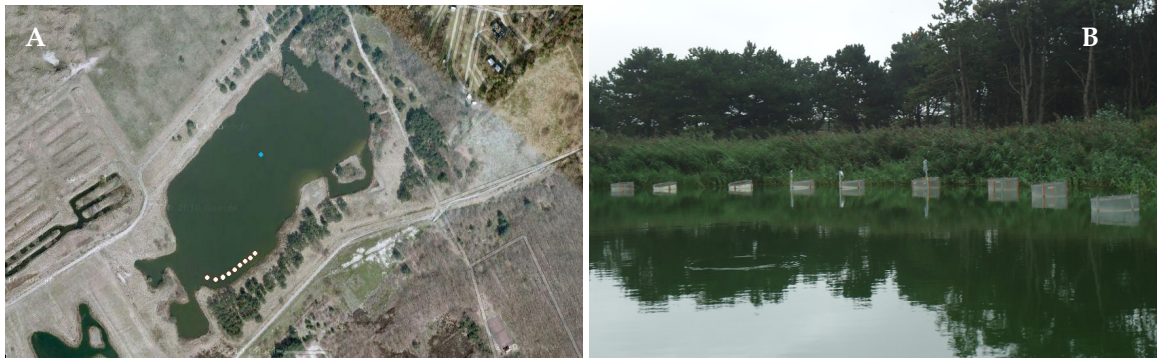
Figuur 6.2 a). Infiltratiebekken Solleveld 12 nabij Monster. De witte stippen geven de locaties van de enclosures aan. De blauwe stip geeft de referentielocatie aan. b). Impressie van de enclosures in het bekken: rechts enclosure M112010 naar links oplopend tot enclosure M112018.
