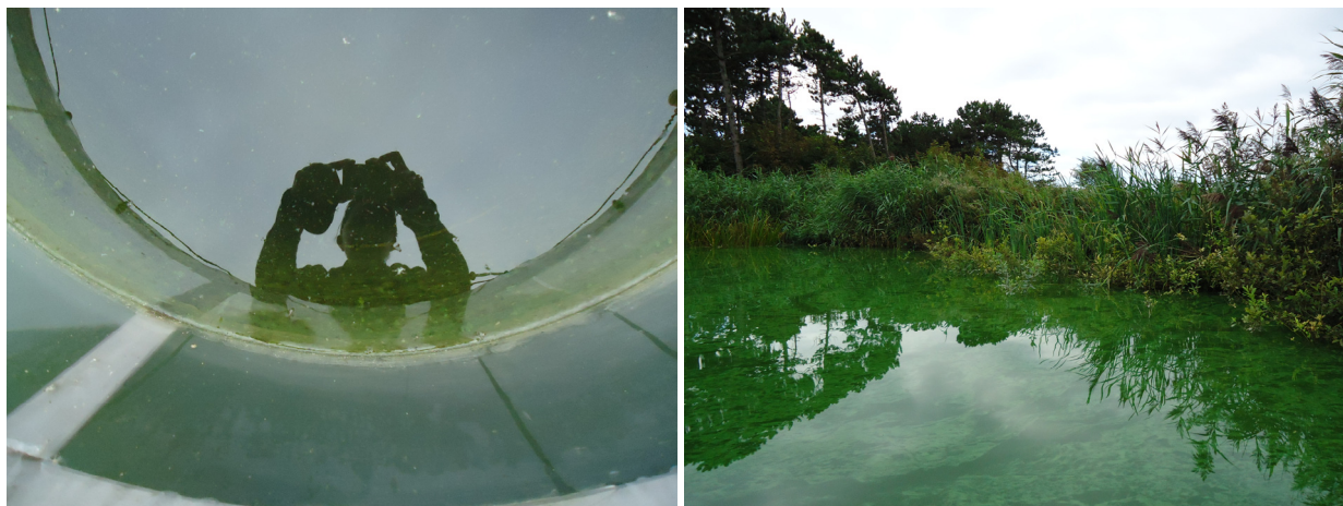
Figuur 6.18. A) geeft een beeld van het doorzicht in de enclosure, er is tot ca. 1,3 meter bodemzicht. B) laat het omringende water zien op hetzelfde moment. Er zijn drijflagen van cyanobacteriën aanwezig die vooral in hoeken van de plas ophopen.
